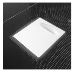
Die Querruderservos müssen sehr dünn sein. Es passen nur 8mm dicke Servos bündig in die Servoschächte. Der Querruderschacht ist vom Stützstoff ausgenommen und durch eine zusätzliche Gewebelage verstärkt um genügend Bauhöhe zu haben. Die Passung der verwendeten Servos ist generell am Modell zu prüfen.
