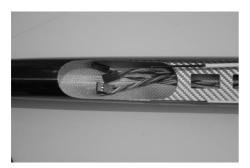
Die vier verbliebenen Servokabel werden paarweise durch die beiden rechteckigen Öffnungen in den Wurzelrippen gefädelt und mit der Steckerseite bis vorne in die Rumpfspitze geführt. Die Kabel verlaufen unterhalb des Servobretts. Gut zu sehen sind hier auch die Öffnungen für die Servos für das V-Leitwerk und die Bowdenzüge für die V-Leitwerks-Anlenkungen.
