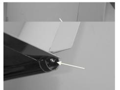
Das V-Leitwerk wird nach Einstecken der fertigen Vierkantsteckungen einfach aufgeschoben und mit Tesa am Rumpf gesichert. Die Verbindung ist jederzeit wieder lösbar um den Rumpf einfacher transportieren zu können. Der Hebel der V- Leitwerksklappen ist dabei vorsichtig durch den Schlitz am Rumpf zu führen. Das Gleiche macht man anschließend auch mit der anderen V-Leitwerkshälfte. Optional kann man die Steckungen im Rumpf mit Epoxy einkleben. Das Leitwerk gewinnt dadurch an Stabilität.
